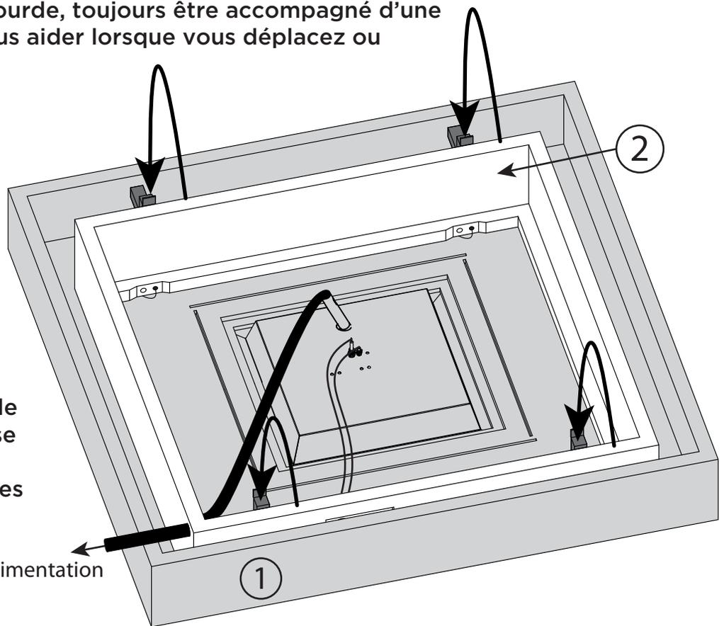
Fixer solidement la base de la table (2) au dessus de table (1) avec 4 rondelles (B) et 4 vis (A) aux 4 supports.
