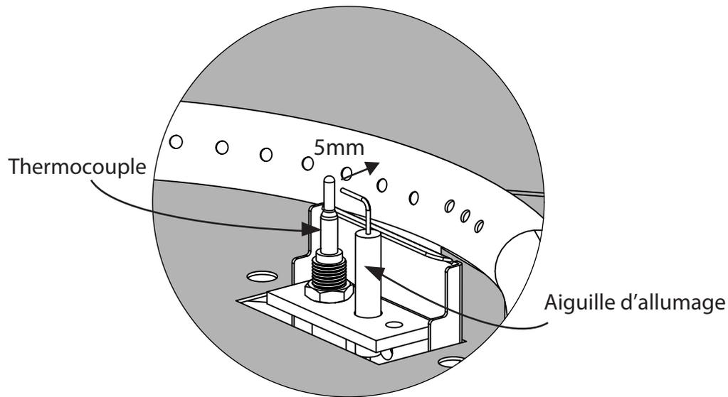
3. Vous assurer que l'aiguille d'allumage et le thermocouple sont correctement positionnés.
