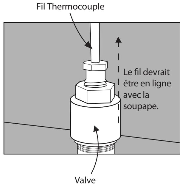
4. Assurez-vous que le fil du thermocouple est correctement positionné. Le fil de thermocouple devrait être en ligne avec la valve.
