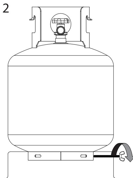
**Raccord du réservoir de gaz PL**
