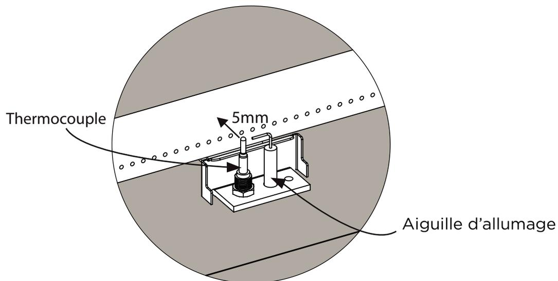
3. Vous assurer que l'aiguille d'allumage et le thermocouple sont correctement positionnés.
