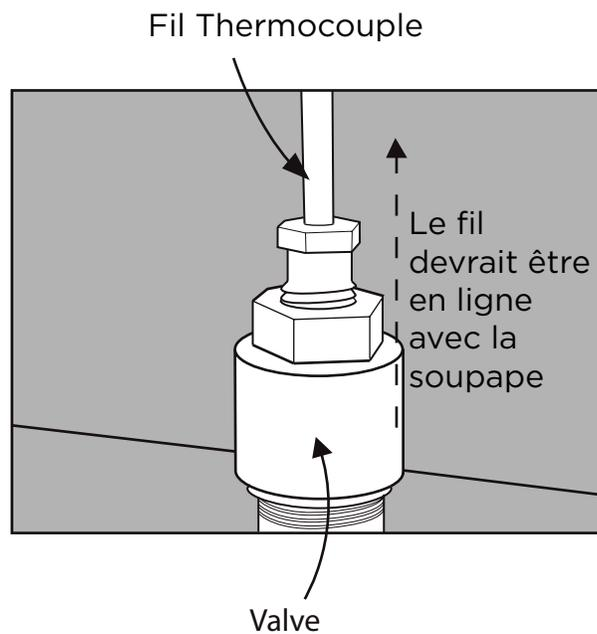
4. Assurez-vous que le fil du thermocouple est correctement positionné. Le fil de thermocouple devrait être en ligne avec la valve.
